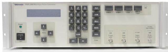
PSPL10000 系列脉冲发生器通过方便的前面板或计算机控制提供了优异的信号完整性。高压输出拥有快速的边沿速率、平滑的跳变和最小的过冲和振铃。可调节输出电平使用内部阶跃衰减器获得，确保在所有设置上实现一致的信号形状。输出是为  $50\ \Omega$  阻抗设计的，但可以安全地驱动从短路到开路的任何负载。
